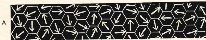
Fig. 5a - Dipoli in stato bilanciato. (Le « forze di attrazione » sono inerti).
