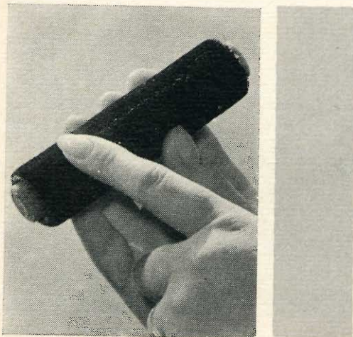
Fig. 12 - Rimozione della polvere raccolta dopo aver eseguito la pulizia di un disco.
