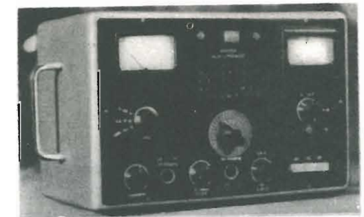
Fig. 1 - A sinistra e al centro si trovano rispettivamente le regolazioni del generatore RC e del signal tracer; a destra si trovano quelle dell'alimentatore stabilizzato.
