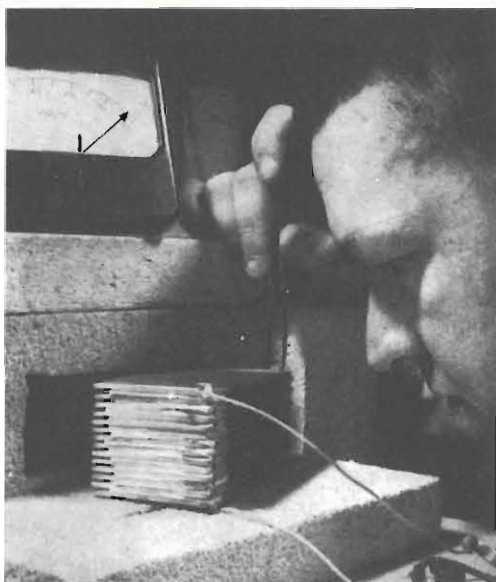
Fig. 6 - Generatore termoelettrico Honeywell per alte temperature. Sono visibili le 14 piastrelle e gli spessori in ceramica porosa.
