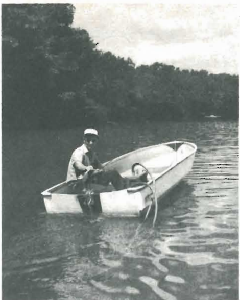
Fig. 5 - Barca da pesca con motore azionato da un generatore termoelettrico.
