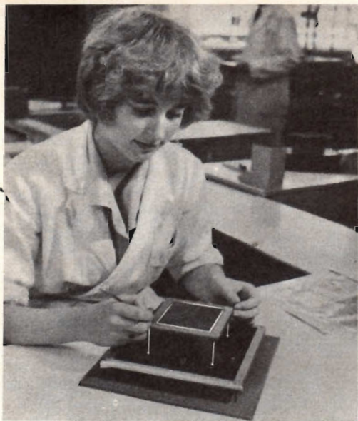
Il conduttore « S » viene disposto diagonalmente nel piano della memoria.
