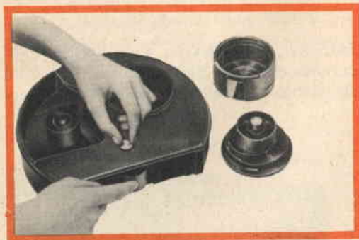
Messa a punto della pellicola nel caricatore « Zeiss ».
