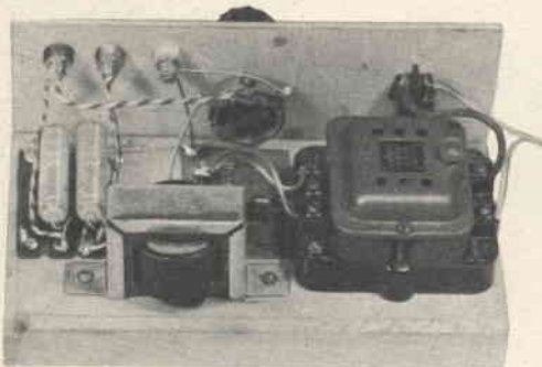
Fig. 3 - Veduta posteriore dell'ALIMENTATORE montato.
