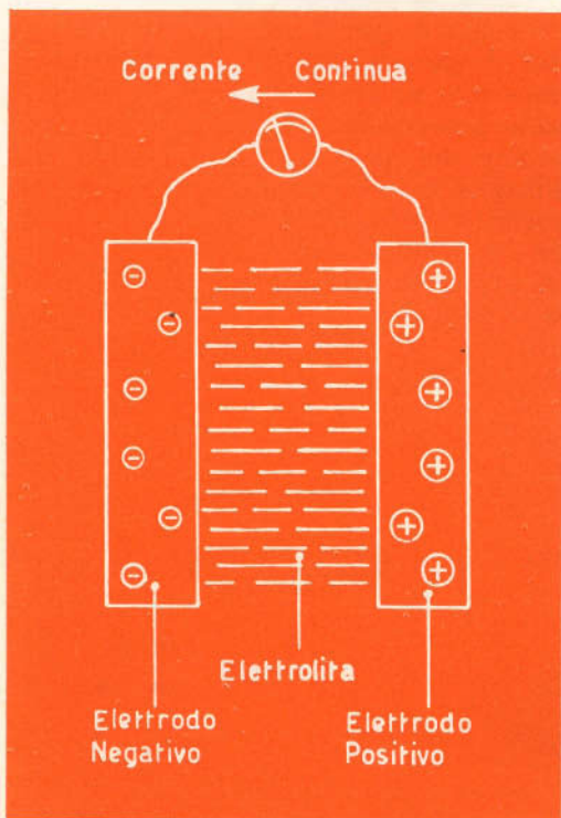
Fig. 4 - Dalla polarità opposta degli elettrodi ha luogo la corrente continua circolante nello strumento.
