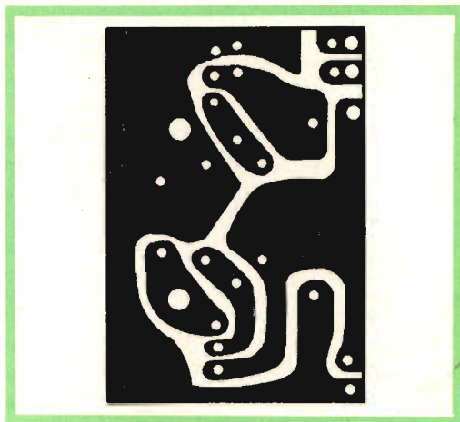
Fig. 5 - Circuito stampato del contagiri riportato in grandezza naturale.
