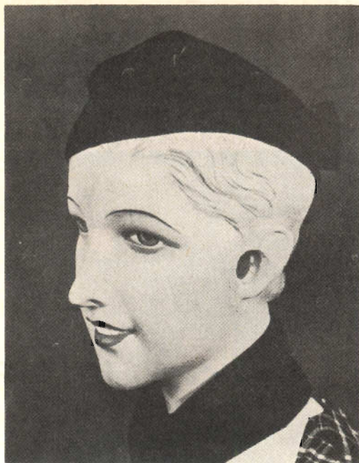
Fig. 6 - Manichino usato nelle prove di registrazione stereofonica con i microfoni vicini, in questo caso erano situati al posto delle orecchie.
