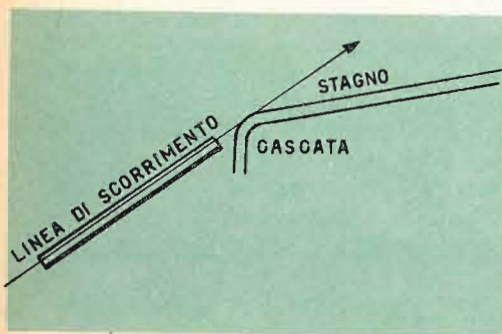
Fig. 6 - Rappresentazione schematica di una saldatrice « a cascata ».
