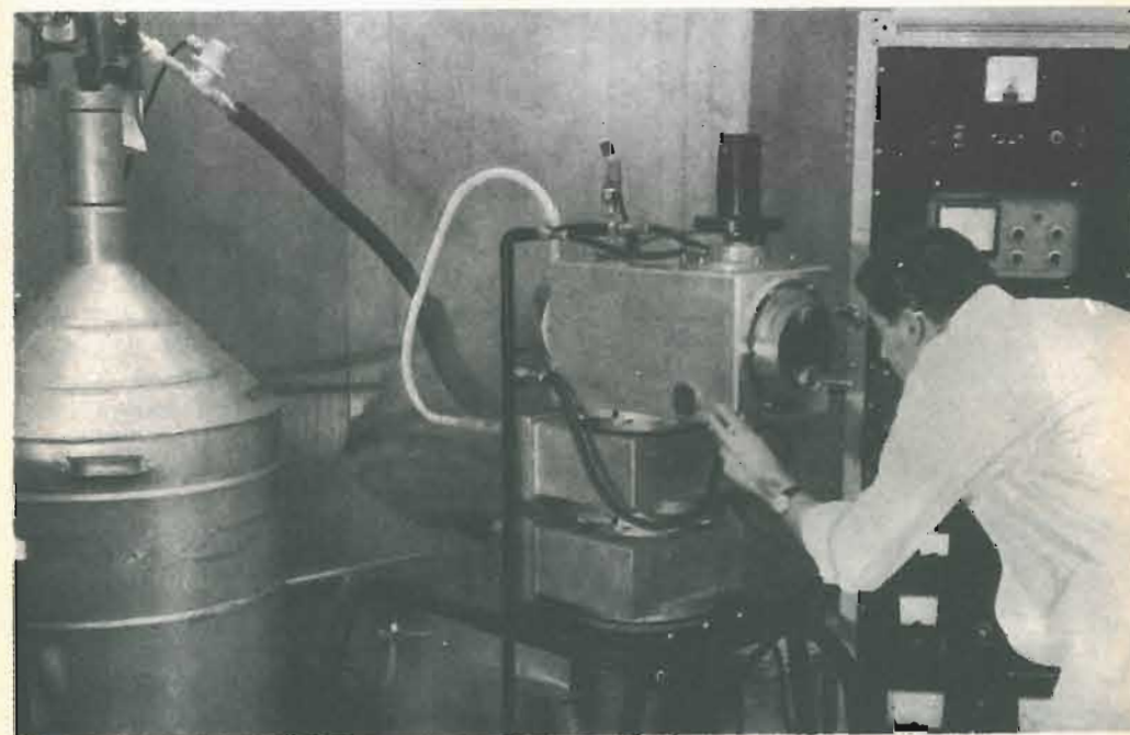
Fig. 20 - Sistema usato dalla General Instrument per depositare sottili strati di tantalio e silicio nella fabbricazione di condensatori ceramici. Lo strato di tantalio può essere depositato soltanto in condizioni di vuoto molto spinto.
