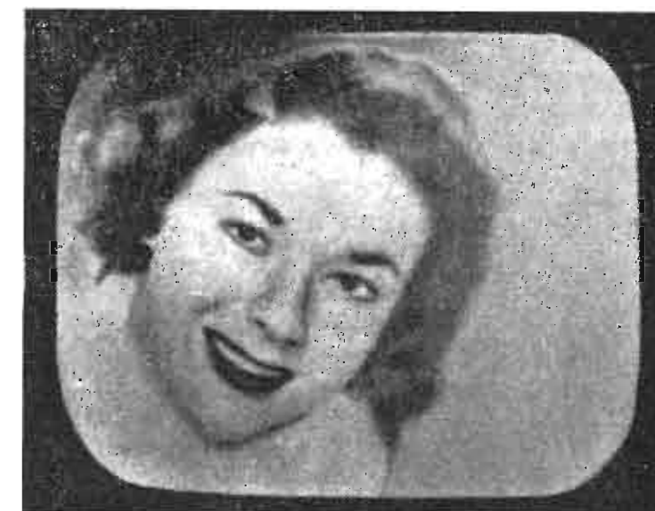
Immagine televisiva ottenuta con la camera di cui sopra. Il soggetto, una fotografia pubblicitaria, è illuminato mediante due lampade « photoflood » da 500 W. La fotografia è stata presa dallo schermo di un tubo da 9 pollici.
