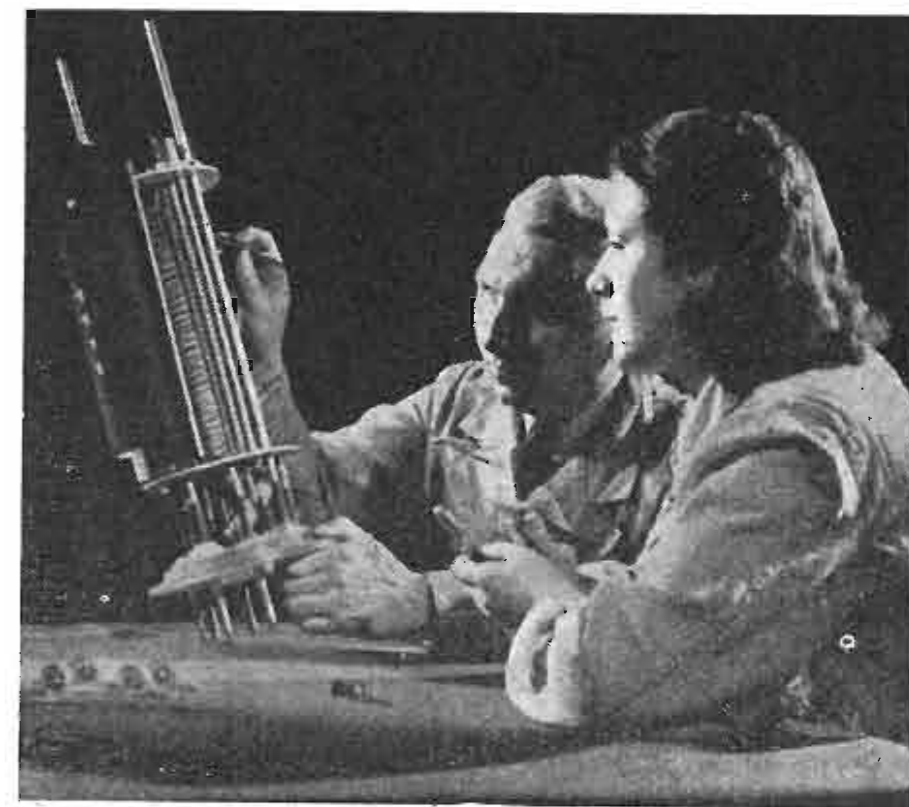
Presso gli stabilimenti Philips di Eindhoven per istruire le maestranze vengono impiegati modelli in scala ingrandita dei tubi elettronici.
