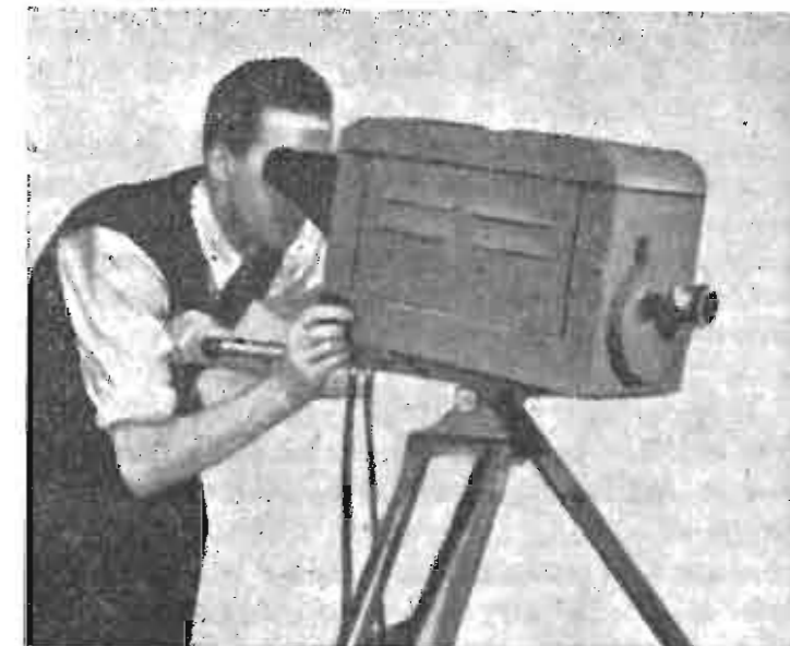
Camera da presa costruita da K.A.J. Russel di Bournemouth. Egli impiega un iconoscopio RCA 5527 che lavora con 250 linee.
