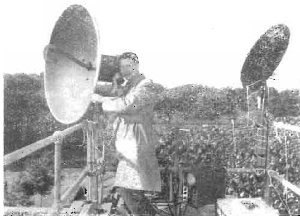
Attrezzata di tutto punto, una stazione mobile riprende sul posto gli avvenimenti sportivi e li trasmette (con le antenne paraboliche a destra ed a sinistra) alla stazione principale che le irradierà nuovamente.
