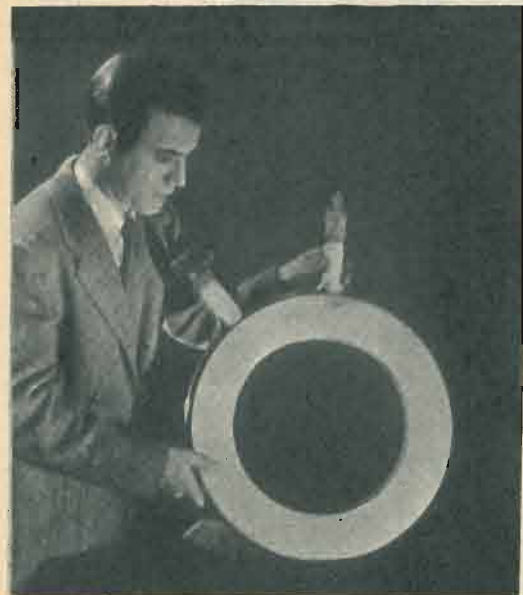
● La ciambella che genera i raggi X nel betatrone può, in caso di sostituzione o per verifiche, essere smontata facilmente in una decina di minuti. Qui sotto ne è indicato schematicamente il funzionamento.
