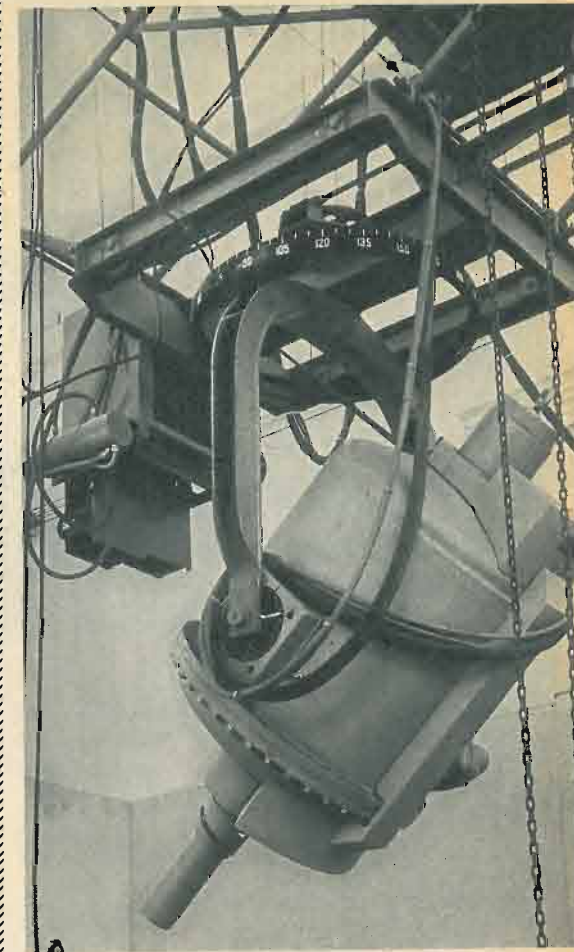
● Il maxitron 1000, acceleratore usato dagli Stabilimenti Ansaldo per radiografare i metalli. Esso ottiene i raggi X da bombardamento di elettroni cui viene impressa una elevatissima velocità.
