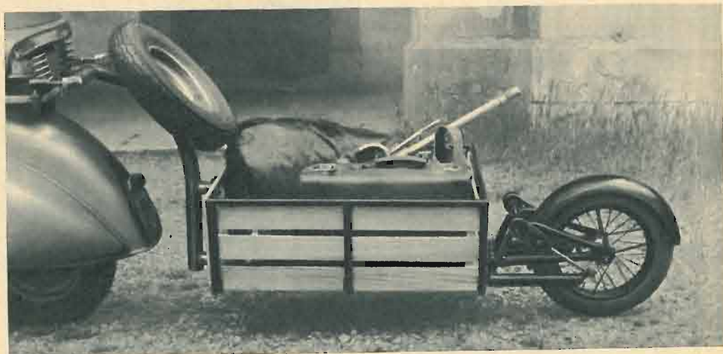
● Il rimorchio monoruota praticamente non aumenta l'ingombro laterale e nello stesso tempo
