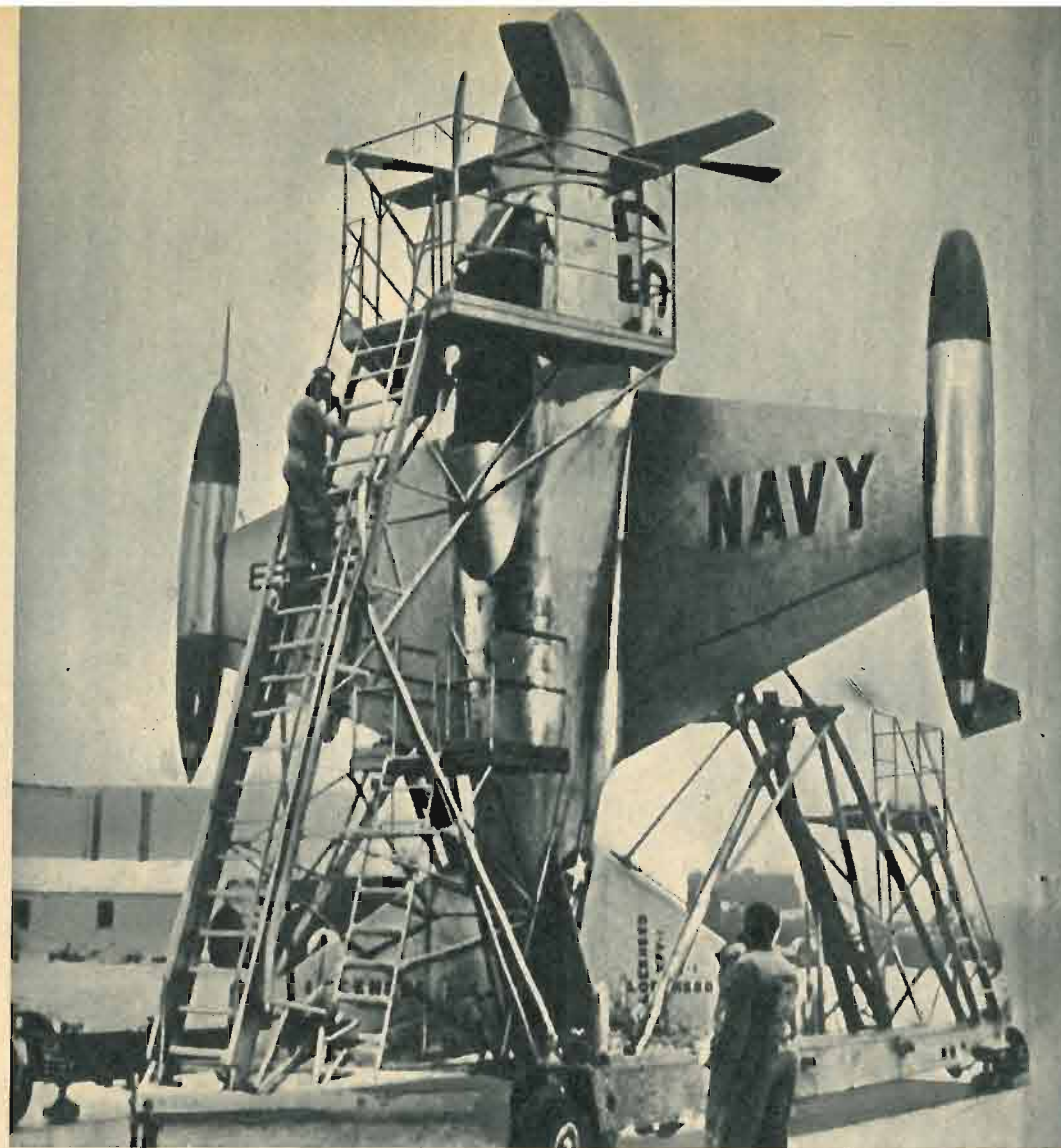
IL LOCKEED XFV-1 NELLA NORMALE POSIZIONE DI DECOLLO E DI ATTERRAGGIO VERTICALE
