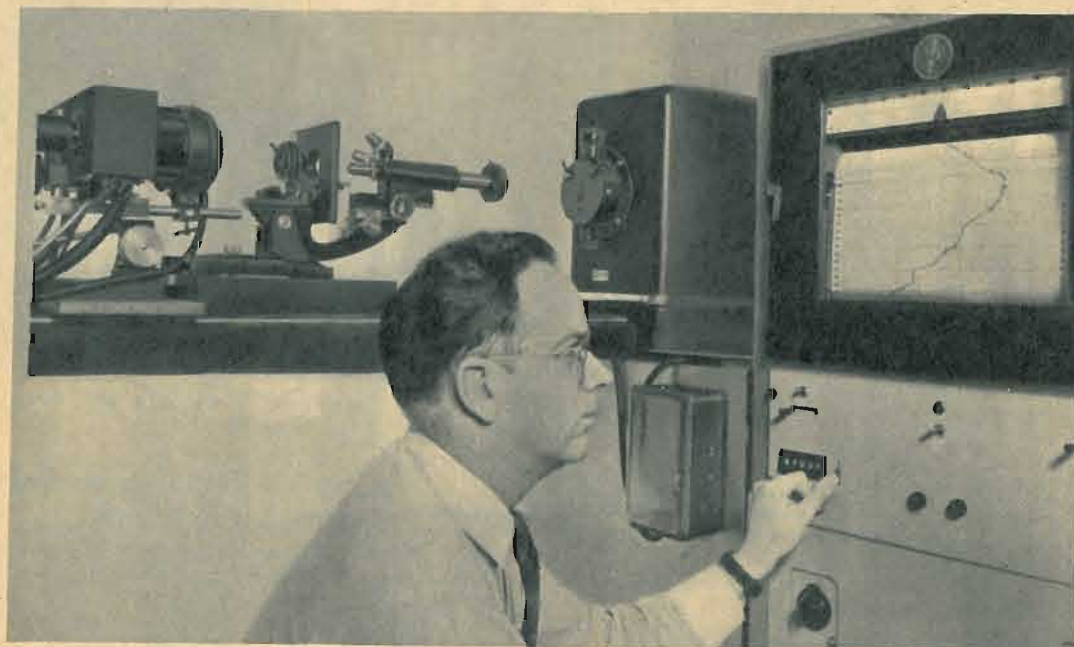
• L'apparecchiatura. Da sinistra a destra: lampada a vapore di mercurio (che produce i raggi ultravioletti), microscopio e spettrofotometro, che registra il diagramma delle intensità spettrali.
