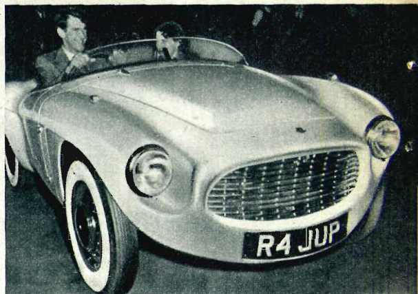
LA JOWETT JUPITER R4 munita di telaio tubolare e carrozzeria in plastica. Il motore eroga 65 cav e dà una velocità di 160 km/h. Al volante della vettura il conquistatore dell'Everest E. Hillary.
