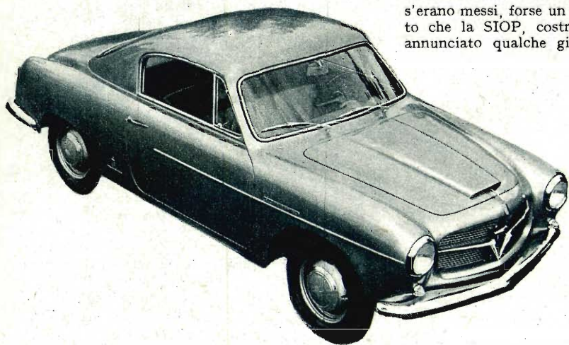
LA FIAT 1100 TURISMO VELOCE carrozzata da Pinin Farina con struttura a scatola. Il motore ha una potenza di 50 cav a 5200 giri con un rapporto di compressione di 7,5:1. La velocità massima del veicolo è di 150 km/h ed il consumo è di 8÷8,5 l per ogni cento chilometri alla velocità di 100 chilometri l'ora.
