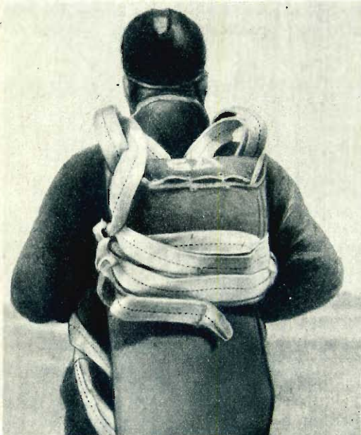
● Paracadute dorsale, del tipo ad apertura automatica come è rivelato dalla cinghia trattenuta con sistema elastico presso i bordi della custodia.
