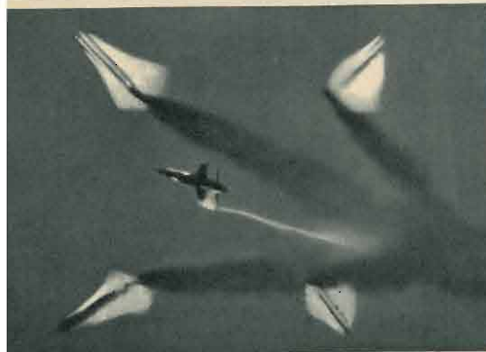
Questo missile guidato britannico è stato esposto nel settembre scorso da Armstrong-Whitworth a Farnborough. Gli otto razzi di partenza sono disposti a gruppi di due fra le ali. Le due foto in basso li mostrano quando si separano dal missile.
