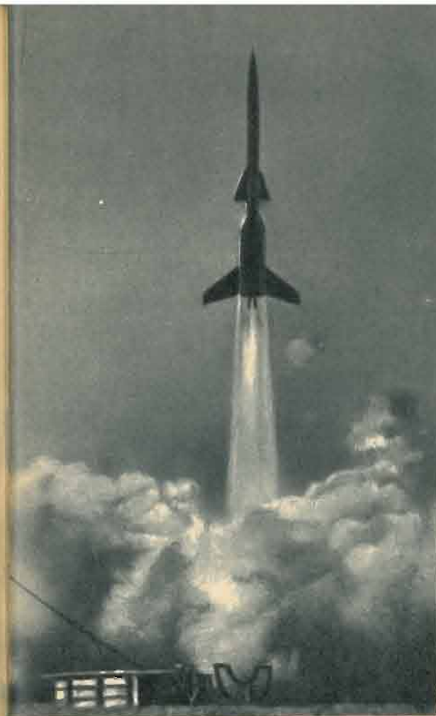
La partenza verticale di un missile guidato terra-aria, a due stadi, costruito in Francia. In questa fase è acceso solamente il razzo di partenza.
