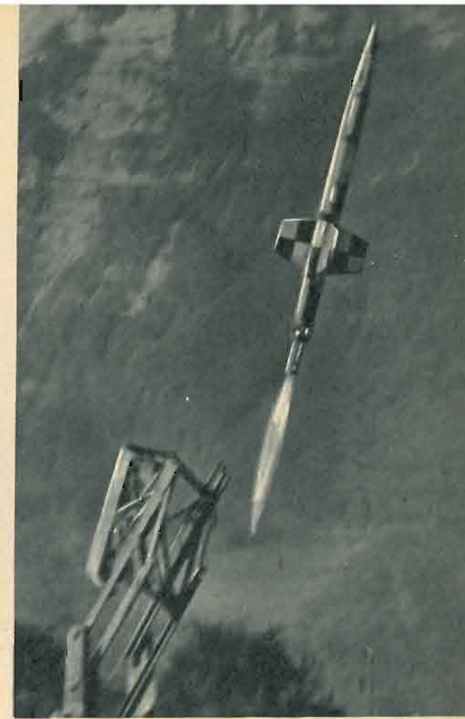
Lancio del missile terra-aria Oerlikon , ad autoguida indiretta in un fascio radar. Calibro 0,40 m, lunghezza 4,80 m. La gittata è di 20 chilometri.
