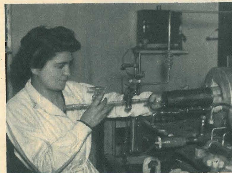
La vuotatura e il riempimento con argon di un contatore proporzionale di particelle.
