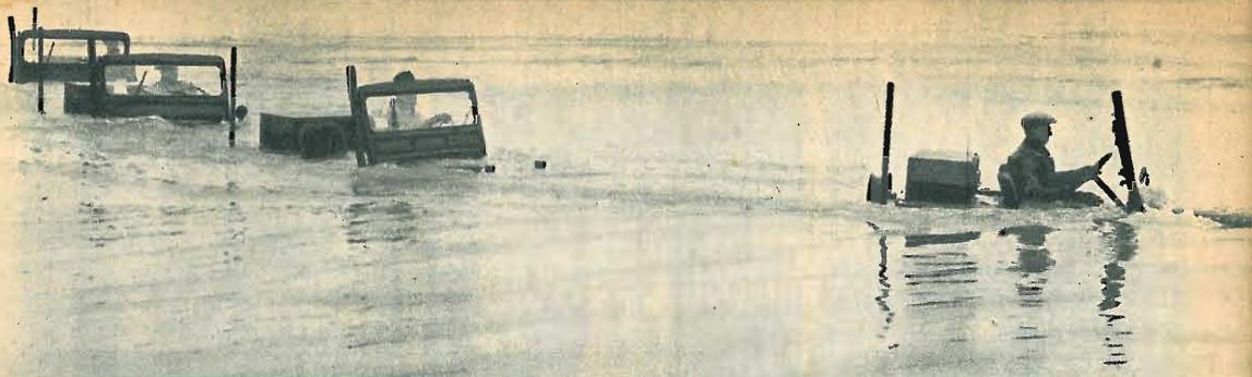
Ecco alcune jeep del tipo subacqueo mentre eseguono una prova di attraversamento in convoglio
