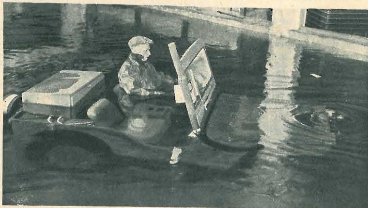
← La nuova jeep in immersione. Anteriormente il tubo d'immissione dell'aria; il tubo di scarico emerge posteriormente.
