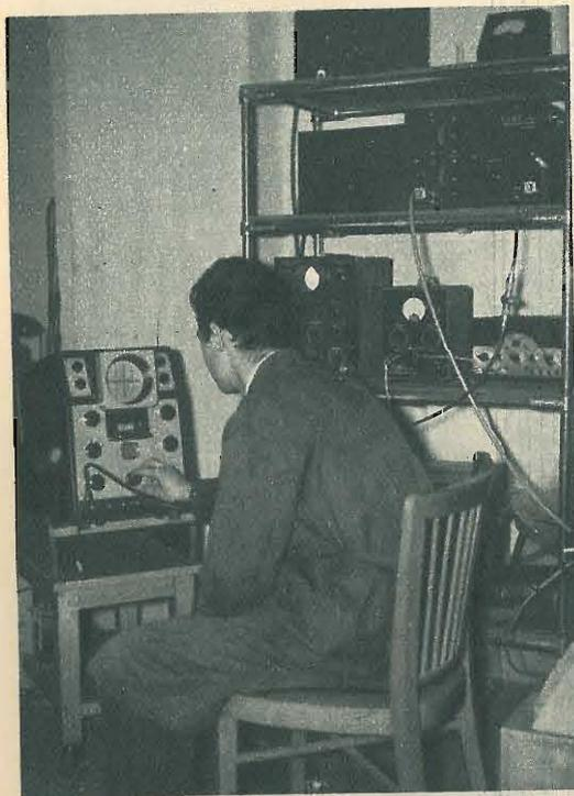
• Questa apparecchiatura elettronica è connessa ad una camera di ionizzazione (a trifluoruro di boro) e serve alla rivelazione di neutroni lenti.
