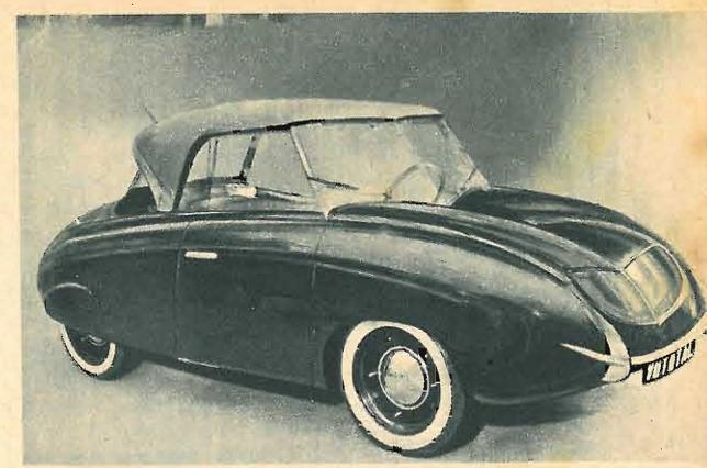
**HENRI LABOURDETTE.** Prototipo di cabriolet a 3 posti a visibilità integrale; parabrezza Vistotal; cofano anteriore abbassato verso il centro; carrozzeria portante; motore Renault a 4 cavalli.
