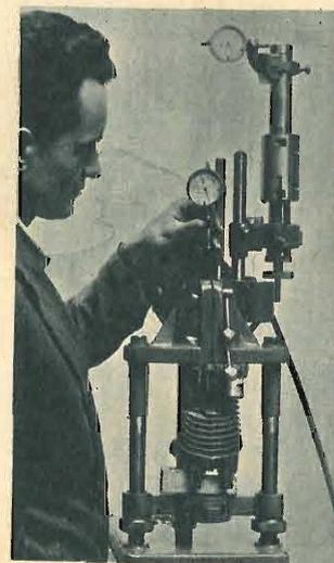
*Centrata e alesatura in 5 minuti di qualsiasi tipo di cilindro, a testa cieca o riportata, dal Ø di 34,2 al Ø di 59 millimetri*
