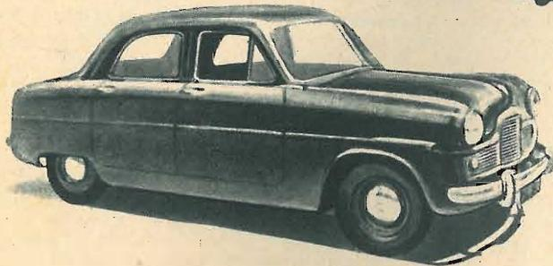
FORD INGLESE. Sul nuovo modello Consul è montato un motore a 4 cil. a valvole in testa (79,37x76,2; 1508 cc). L'autotelaio, molto basso, è a ruote anteriori indipendenti. (Singolare la forma data al predellino.)
