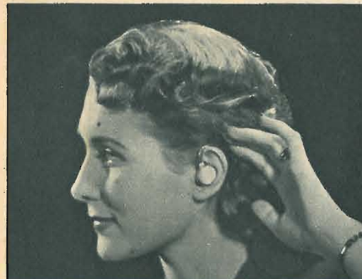
Questo ricevitore a conduzione ossea, ben dissimulato dietro l'orecchio e seminvivibile comprende...
