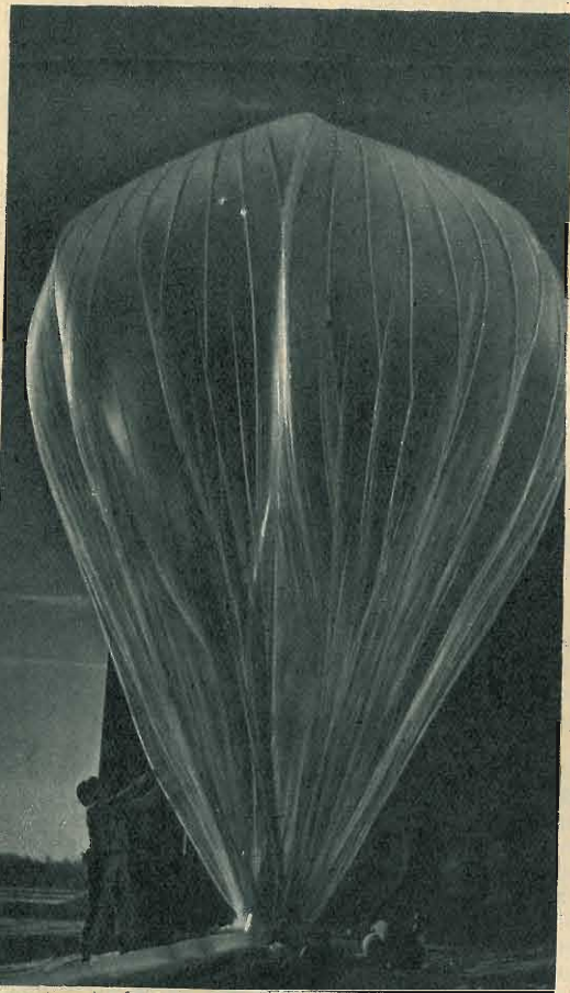
Questo pallone sonda si dilaterà nella stratosfera fino a raggiungere il diametro di 21 metro.
