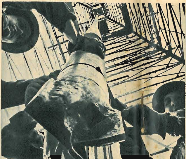
Derrick d'un pozzo di petrolio, visto dall'interno, nel momento in cui sta per scendere la trivella fissata all'estremità del tubo.
