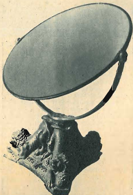
Con questo specchio ustorio di 1,13 m di diametro, Cassini poté fondere ferro e argento.
