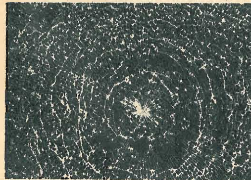
Per effetto di un urto, il cristallo temperato (Securit) si frantuma in infiniti frammenti smussati; ma la visibilità ne risulta molto diminuita.
