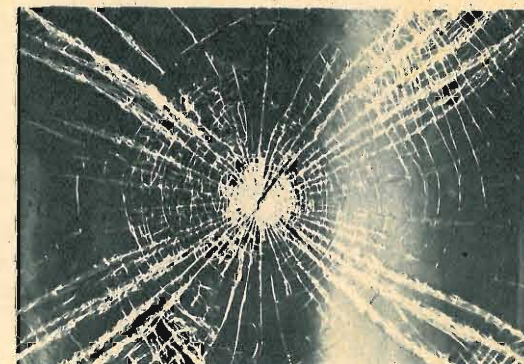
Le lastre a strati sovrapposti (Vis) si rompono in pezzi più lunghi e conservano una miglior trasparenza; ma alla rottura basta un urto più leggero.
