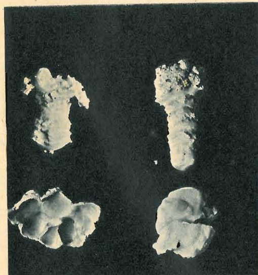
Materiali refrattari fusi nel forno solare con riforamento continuo del crogiole. Essi sono: la torina (punto di fusione 3000^{\circ}\text{C} ), l'allumina ( 2050^{\circ}\text{C} ), l'ossido di berillio ( 2570^{\circ} ) e lo zircono ( 2680^{\circ}\text{C} ).
