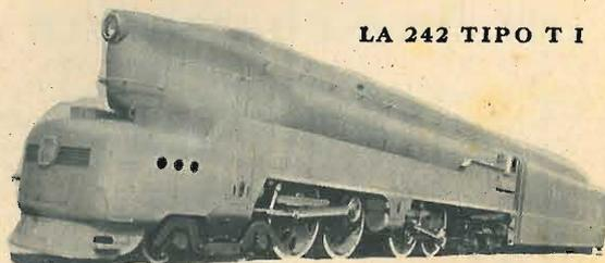
Sagomare la parte anteriore non consiste però nel darle una forma eccessivamente aguzza. Occorre invece ottenere uno scorrimento laminare dell'aria lungo la macchina, evitare, cioè, il distacco dei filetti d'aria che è generatore di vortici: l'identico problema che per le ali di un aereo.
