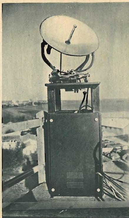
Proiettore di radar meteorologico per rilevare a grande distanza formazioni nuvolose.
