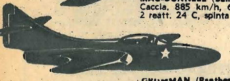
GRUMMAN (Panther) Caccia, 900 km/h, 1 reatt. « Nene », spinta 2270 kg.
