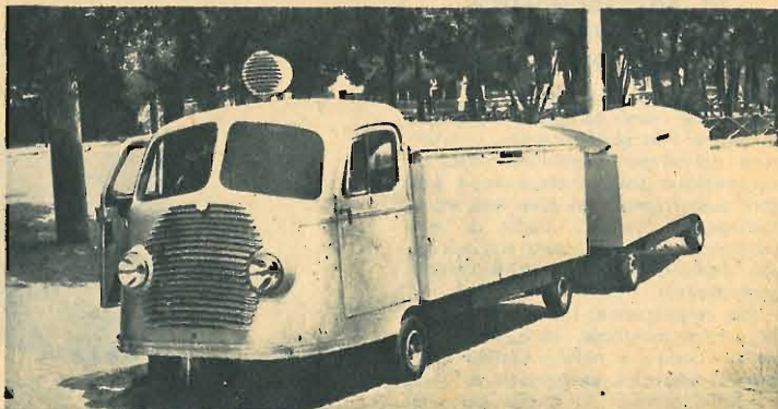
Autobottega Jacomelli in posizione di trasferimento: telaio speciale, con motore FIAT 1100 e rimorchio. Lunghezza complessiva del treno all'incirca 9 m; dell'avantreno motore 1,40 m; larghezza 1,55 m. Portata complessiva: da 6 a 10 quintali di merce; la velocità massima è di 40 chilometri all'ora, in ogni caso più che sufficiente allo scopo.
