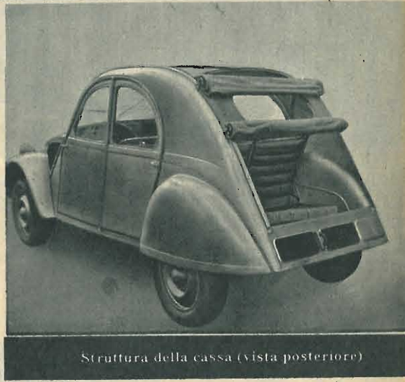
La nuova Citroën 2 cav, a quattro posti, struttura a guscio apribile, a trazione anteriore
