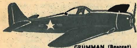
GRUMMAN (Bearcat) Caccia, 640 km/h, 3,8 t motore Double Wasp, 2100 cav.
