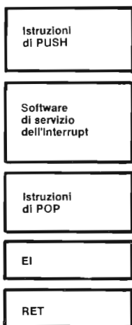
Figura 23-10. Una tipica subroutine di servizio dell'interruzione. Le prime istruzioni, le istruzioni PUSH, conservano lo stato del microcomputer. Vicino alla fine della subroutine, lo stato del microcomputer viene ripristinato nei registri interni.
