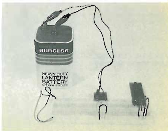
Figura A-4. Esempio di utilizzo di una batteria per alimentare l'SK-10. L'LR-1 Power Outboard serve per dare tensione a 50 terminali del bus di alimentazione. I restanti 50 terminali sono collegati ai precedenti con ponticelli, che devono sempre restare collegati.
