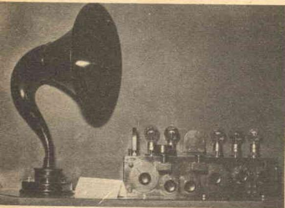
**1925** Le prime « neutrodine » con l'altoparlante a collo di cigno dei primi radioamatori.
