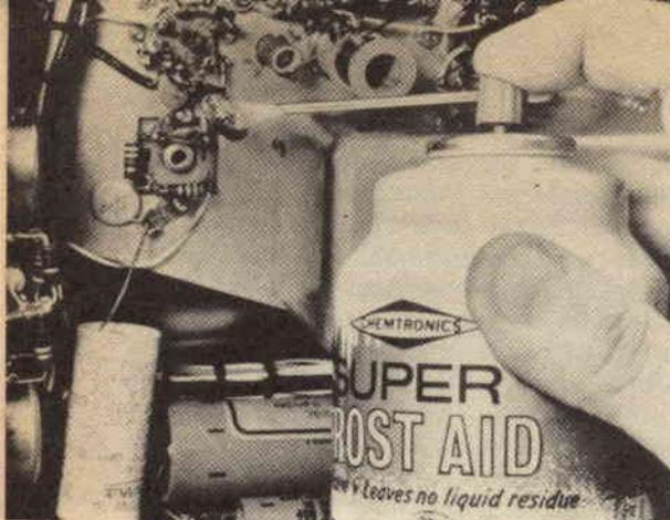
Un difetto di fabbricazione di un condensatore di fuga provocava perdita di sensibilità e funzionamento irregolare in questo apparecchio. La perdita di segnale era graduale dopo un'ora di funzionamento del ricevitore. Raffreddando i componenti sospetti con un liquido frigorifero a spruzzo, il condensatore difettoso venne presto individuato e il difetto eliminato.
