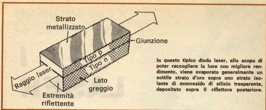
In questo tipico diodo laser, allo scopo di poter raccogliere la luce con migliore rendimento, viene evaporato generalmente un sottile strato d'oro sopra uno strato isolante di monossido di silicio trasparente, depositato sopra il riflettore posteriore.
