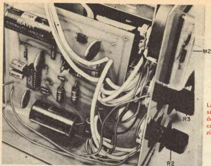
La costruzione non è critica e perciò si può adottare qualsiasi disposizione dei componenti. I fili in cui scorre corrente devono essere di grossa sezione per evitare che si riscaldino.
