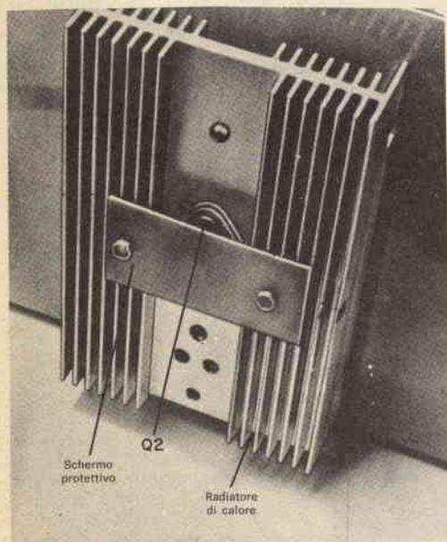
Coprendo l'involucro del transistore con uno schermo di plastica, si evita la possibilità di cortocircuiti accidentali nella parte posteriore.
