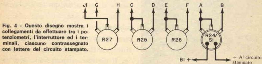
Fig. 4 - Questo disegno mostra i collegamenti da effettuare tra i potenziometri, l'interruttore ed i terminali, ciascuno contrassegnato con lettere del circuito stampato.
