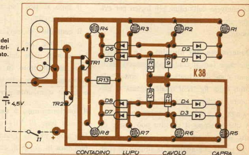
stessa riva. Di conseguenza, le resistenze dei fotoresistori R1, R2, R3, R4 avranno un valore elevato, e pertanto sui punti *a-b* sarà presente una tensione positiva: tale tensione però non potrà raggiungere la base di TR1, a causa dell'elevato valore di R4. Inoltre, R5, R6, R7, R8, che si trovano sull'altra riva del fiume, saranno illuminate e sui punti *c-d* ci sarà una tensione positiva di piccolo valore, tale da non provocare la conduzione di TR1.
