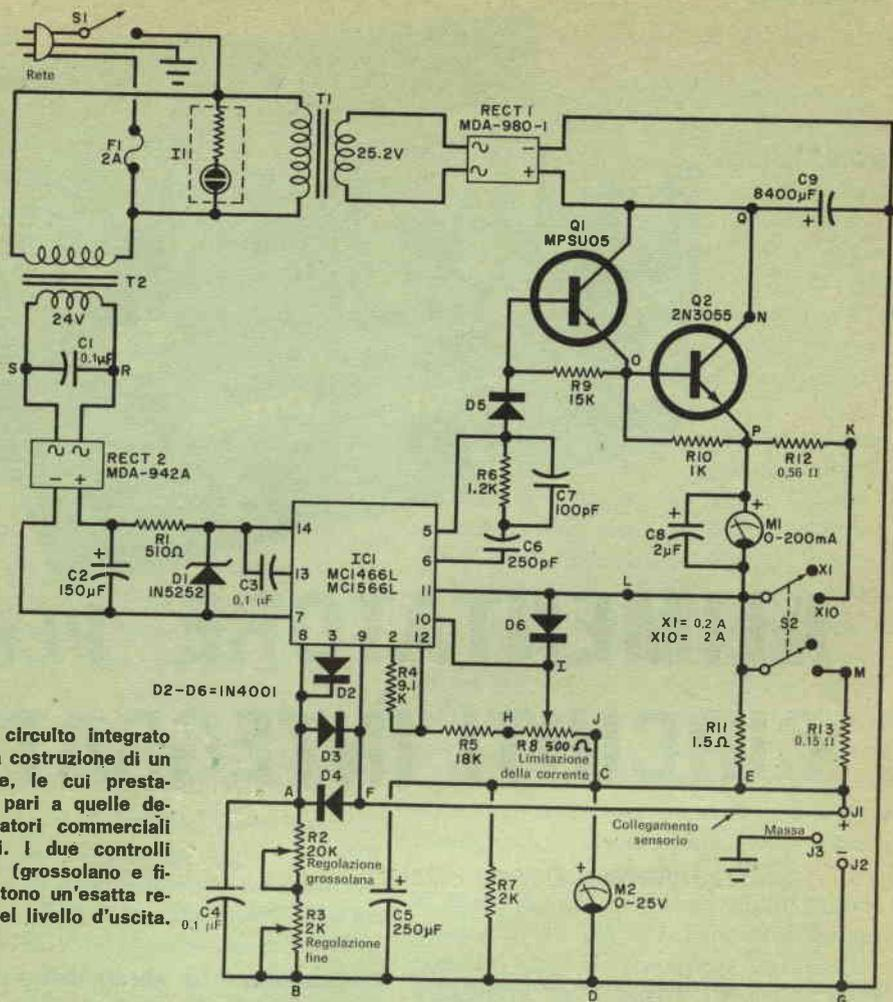
Fig. 1 - Il circuito integrato consente la costruzione di un alimentatore, le cui prestazioni sono pari a quelle degli alimentatori commerciali più costosi. I due controlli di tensione (grossolano e fine) consentono un'esatta regolazione del livello d'uscita.
