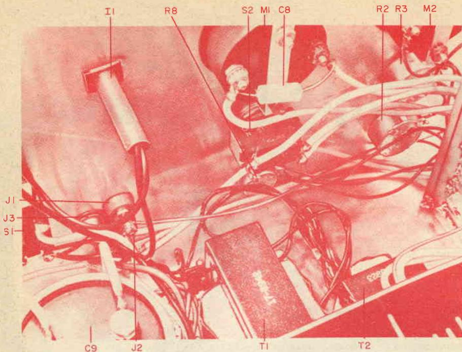
Si noti l'abbondanza di spazio nell'interno del telaio. Ciò, con i fori di ventilazione, consente un funzionamento dell'alimentatore senza molto riscaldamento.
