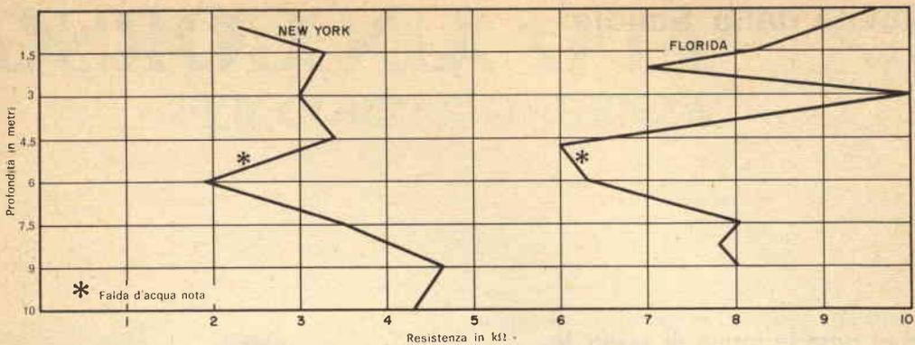
Questi due grafici di prova, relativi a località molto distanti tra loro, mostrano sorprendenti analogie per il fatto che la resistenza (misurata in chilohm) diminuisce apprezzabilmente a quelle profondità alle quali è noto che esiste sicuramente una falda d'acqua.
