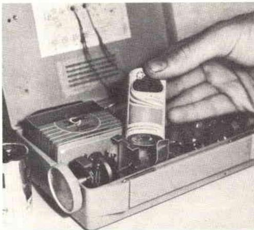
Se il vostro ricevitore portatile impiega comuni pile per lampade elettriche, potete ottenere un maggior numero di ore di funzionamento prima di procedere alla sostituzione, usando in loro vece pile per flash fotografico che hanno durata maggiore e sono costruite in modo da fornire prestazioni più sicure quando sono verso la fine della loro vita. Esse sono reperibili in commercio in diverse forme e dimensioni.
