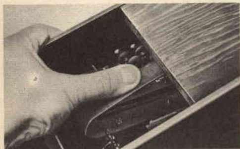
La molla deve essere leggermente premuta per consentire al pedale di scorrere sotto i bordi ripiegati del telaio.
