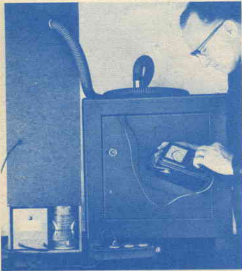
Fig. 9 - Per consentire l'entrata dell'aria e per l'osservazione della lampadina spia, lo sportello frontale non arriva fino al fondo del mobiletto. Per evitare che l'apparecchio possa funzionare con lo sportello aperto, si usa una presa ed una spina di sicurezza come quelli impiegati per i pannelli posteriori dei televisori.
