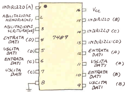
Fig. 1 - Collegamenti ai piedini della RAM 7489.
