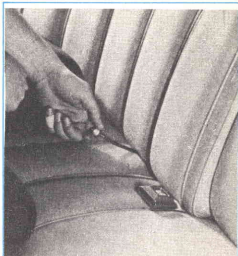
Fig. 8 - Si fa passare il cavo dal bagagliaio all'interno della vettura.
