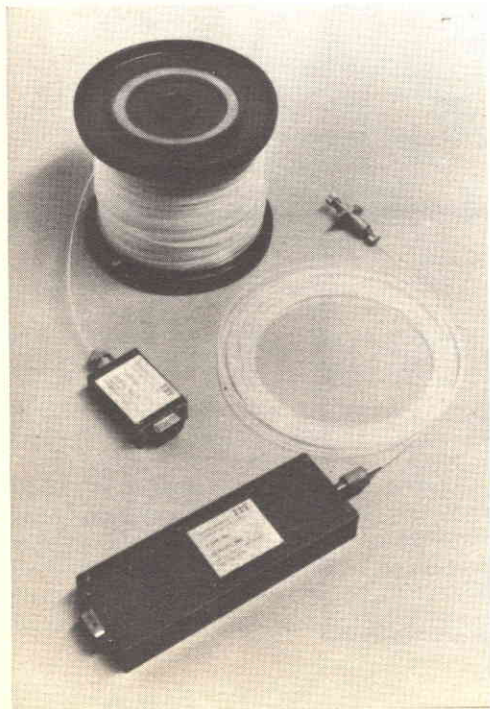
Fig. 3 - Alcuni dei componenti che formano il sistema di collegamento a fibre ottiche per la trasmissione di dati, prodotto dalla ITT.
