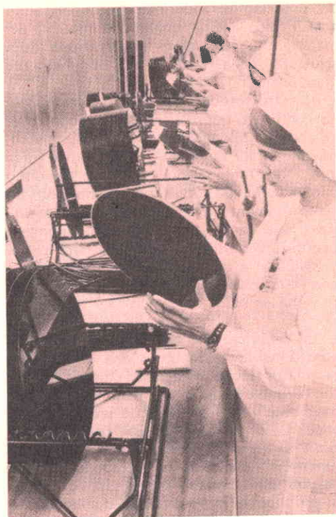
Fig. 2 - Esame del disco di lacca effettuato in una camera assolutamente pulita; molte altre operazioni vengono effettuate sul disco in condizioni di perfetta pulizia.
