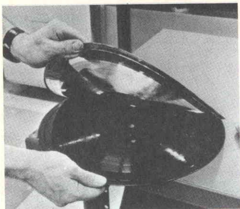
Fig. 4 - Il disco di lacca viene separato manualmente dalla deposizione galvanica che costituisce il "padre".
