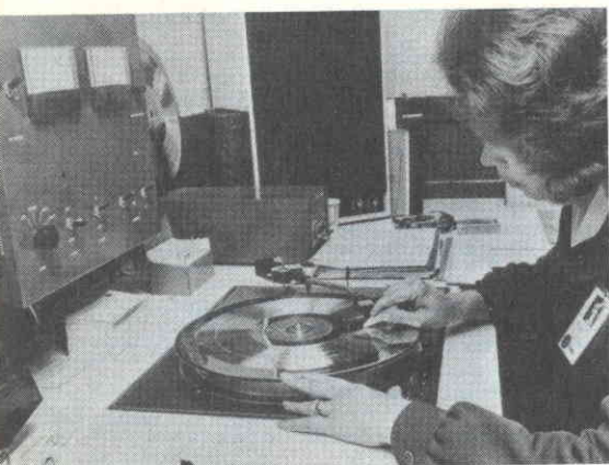
Fig. 5 - La "madre" di metallo viene riprodotta su un giradischi per controllare eventuali difetti che verranno eliminati con un procedimento di "microchirurgia".
