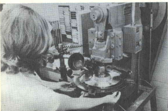
Fig. 6 - L'esatta determinazione del centro del disco avviene facendo ruotare il disco per mezzo di una speciale macchina fino a che il solco non appare immobile.
