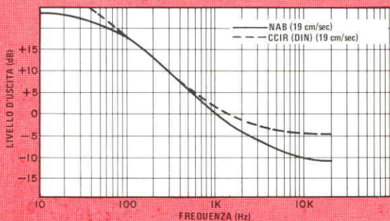
Fig. 8 - Due curve standardizzate per l'equalizzazione in riproduzione nei registratori a bobine
