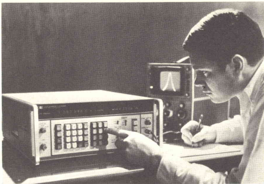
Fig. 4 - Il modello 3330 B, della Hewlett-Packard, usa interruttori a pulsante per la selezione automatica della componente armonica desiderata.
