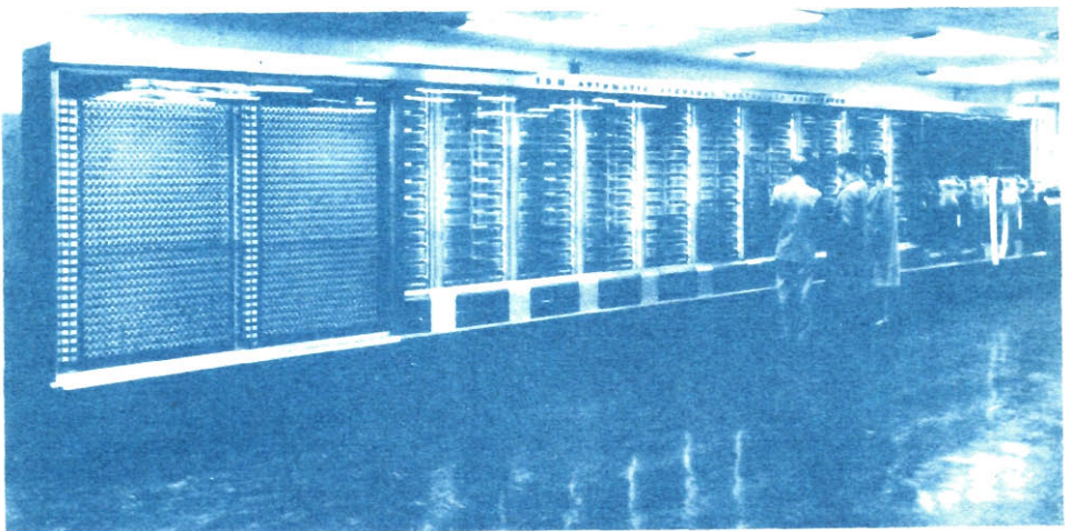
Il calcolatore IBM A.S.C.C., chiamato anche Harvard Mark I, fu il primo calcolatore digitale, elettromeccanico per impieghi generali. Semplice in apparenza, esso usava ruote di calcolo e relé; relativamente piccolo di ingombro, richiedeva scarsa manutenzione ma la velocità di calcolo era bassa.
