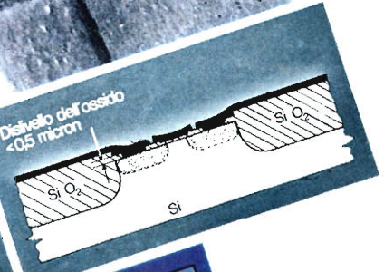
Sopra laboratorio di metallizzazione A sinistra processo MOS convenzionale A destra processo PLANOX Microfotografia 5000 volte ingrandimento
