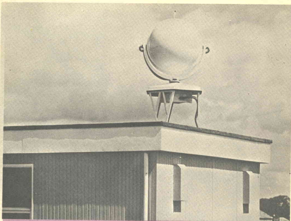
Fig. 2 - Installazione permanente tipica del radar per la ricerca dei venti, con aereo montato sul tetto.
