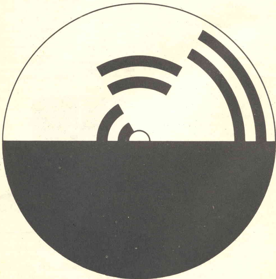
Fig. 1 - Ritagliate questo disco Benham, incollatelo su un pezzo di cartone e con uno spillo fissatelo ad una gomma per cancellare. Fate quindi ruotare il disco alla velocità di 3-10 giri al secondo. La velocità di rotazione influirà sulla tinta e saturazione dei colori. Cambiando direzione di rotazione, la sequenza dei colori resterà invertita.
