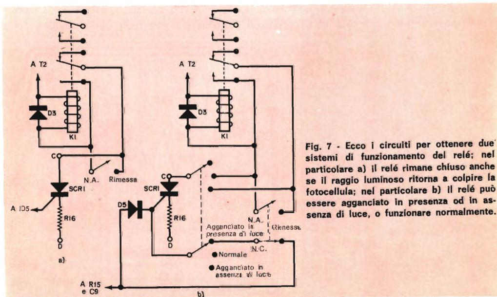
Fig. 7 - Ecco i circuiti per ottenere due sistemi di funzionamento del relé; nel particolare a) il relé rimane chiuso anche se il raggio luminoso ritorna a colpire la fotocellula; nel particolare b) il relé può essere agganciato in presenza od in assenza di luce, o funzionare normalmente.
