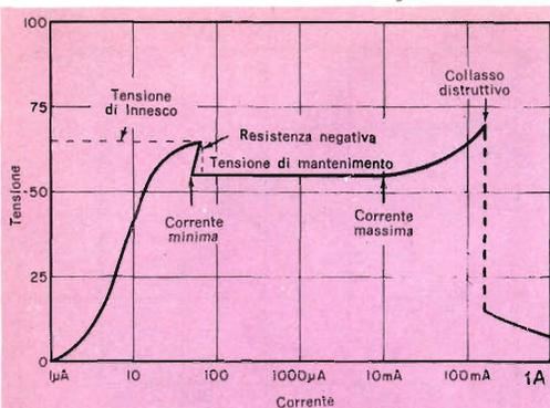
**Fig. 1 - Caratteristica tensione-corrente tipica di una lampadina al neon. I valori non si riferiscono ad un tipo specifico. La corrente prima dell'innesco può essere molto inferiore a quella indicata: si noti che la scala delle correnti è logaritmica e non lineare. La regione normale di funzionamento cade nel tratto piano tra le punte di corrente minime e massime indicate. Il collasso distruttivo cambia le caratteristiche della lampadina, rendendola quindi inutilizzabile.**
