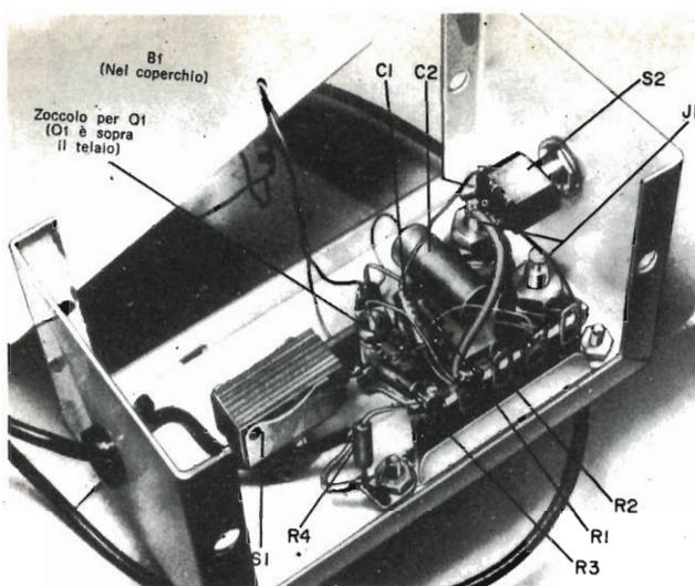
Fig. 6 - Anche i collegamenti del preamplificatore a FET si eseguono da punto a punto. Il circuito deve essere accuratamente schermato per ridurre al minimo il ronzio. L'interruttore S2 è montato su un'estremità della scatola e S1 nel pannello superiore.
