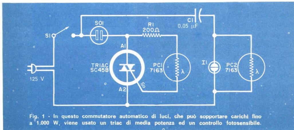
Fig. 1 - In questo commutatore automatico di luci, che può sopportare carichi fino a 1.000 W, viene usato un triac di media potenza ed un controllo fotosensibile.
