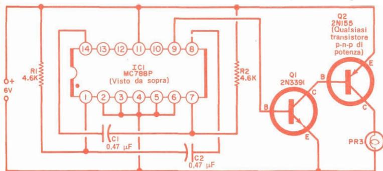
**Fig. 4 - Questo modulatore di alta potenza ha una portata maggiore della versione a torcia. Se la lampadina viene montata entro un riflettore da 7 cm oppure più grande, esso può essere usato in un sistema antifurto.**
