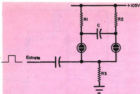
**Fig. 8 -** Mediante l'applicazione di un impulso positivo in entrata, il circuito flip-flop commuta da una lampadina al neon all'altra. Se i valori dei resistori non sono giustamente proporzionati, il circuito può oscillare o comportarsi come un multivibratore monostabile. Lo schema di un circuito pratico è riportato nella figura 9.
