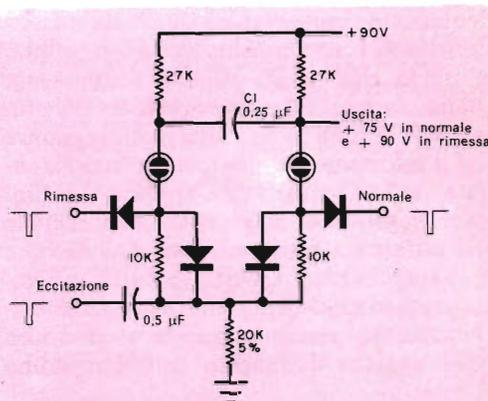
**Fig. 9 -** Questo circuito potrebbe essere usato per costruire contatori binari od altri circuiti numerici. Ogni flip-flop può essere pilotato direttamente dall'uscita del flip-flop precedente. I diodi devono essere identici ed equivalenti al tipo 1N91. Il diodo 1N34 non funzionerebbe.
