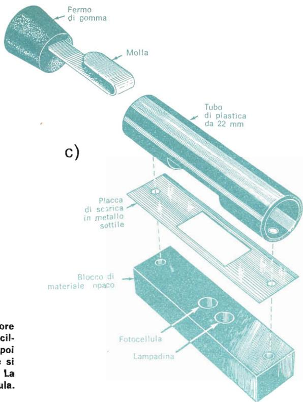
**Fig. 3 - Per realizzare la base del trasduttore si può usare qualsiasi materiale opaco facilmente lavorabile. Su di esso si praticano poi i fori necessari e si montano le parti, come si vede nel particolare c) di questa figura. La placca di scarica si collega alla fotocellula.**
