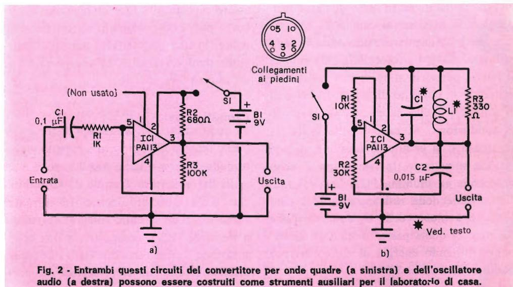
Fig. 2 - Entrambi questi circuiti del convertitore per onde quadre (a sinistra) e dell'oscillatore audio (a destra) possono essere costruiti come strumenti ausiliari per il laboratorio di casa.
