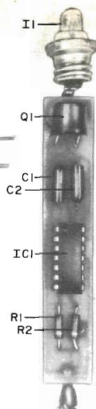
cro standard TO-5 e può essere introdotto, con attenzione, nella scatola. Alcuni fabbricanti collegano uno degli elettrodi di questo transistor all'involucro; è bene quindi isolare la scatola dal transistor con nastro adesivo, allo scopo di evitare cortocircuiti con la scatola del modulatore.
