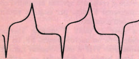
Distorsione inserita - Controllo R6 al massimo - Entrata 60 mV
