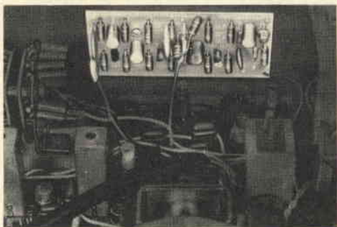
Il circuito stampato può essere montato in una custodia a parte o dentro il mobile del trasmettitore, come illustrato in questa figura.
