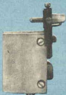
Fig. 4 - I due spinotti che si inseriscono direttamente nel misuratore devono essere tenuti fermi da due viti. Praticate i fori per dette viti in modo che essi vengano a trovarsi in posizione di angolo retto l'uno rispetto all'altro.
