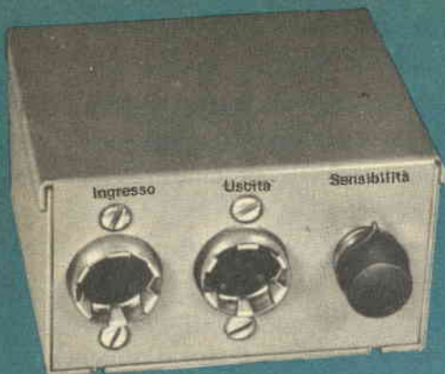
Fig. 7 - Montando l'interruttore sul controllo della sensibilità, si ottiene una semplice unità, facile da azionare, controllata mediante un'unica manopola. I jack d'ingresso e d'uscita possono essere di qualsiasi tipo, purché con 4 piedini.
