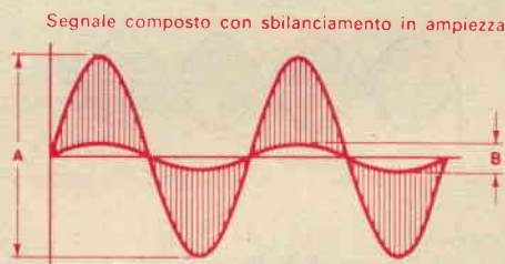
Fig. 7 - Segnale composto con squilibrio di ampiezza. "B" rappresenta il segnale sul canale di destra dovuto all'ingresso sul canale di sinistra.
