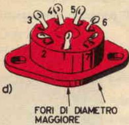
Fig. 2 - Numerazione dei piedini degli zocchi portatubo.
