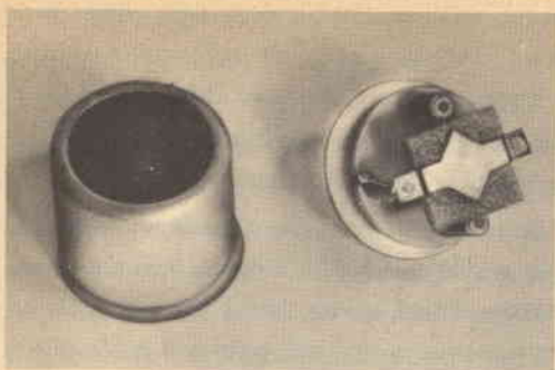
Fig. 5 - Se nel trasduttore trasmettente si determinano vibrazioni che producono un suono percepibile, per ovviare a ciò basta aprire delicatamente la custodia ed inserire un piccolo pezzo di materia plastica spugnosa sotto il cristallo.
