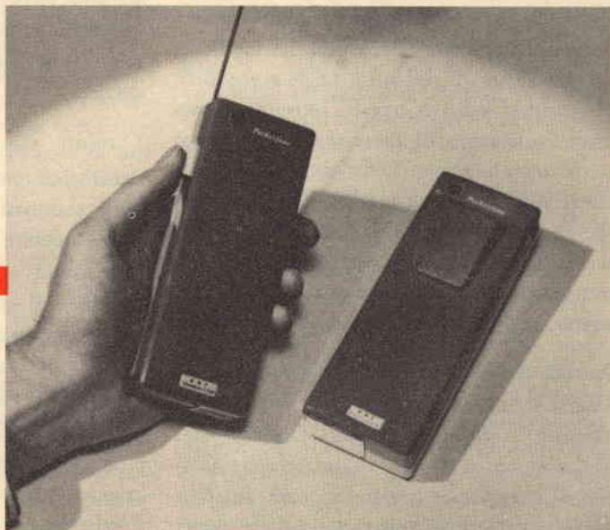
Ecco come si presenta il radiotelefono portatile Pocketfone: a sinistra è visibile il trasmettitore con l'antenna estratta, a destra il ricevitore.
