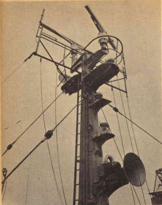
Ecco i due dispositivi di esplorazione del Trawler Twin: uno da 2,40 m, l'altro da 1,80 m.
