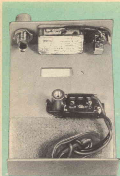
Il microfono è semplicemente incollato alla scatola. Il foro di fissaggio, nel retro della custodia, deve combaciare con quello del distanziatore.
