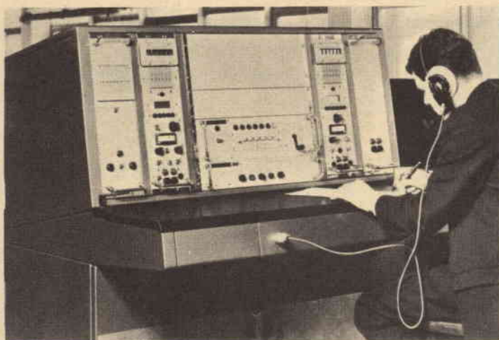
Ecco il quadro di controllo a distanza del sistema di comunicazioni Speedrace.
