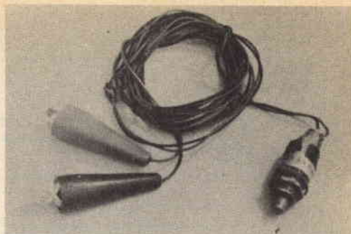
Questo semplice accessorio per far girare il motore consta di due pinze collegate a due fili e di un interruttore a pulsante. I fili si collegano ai terminali del solenoide d'avviamento.
