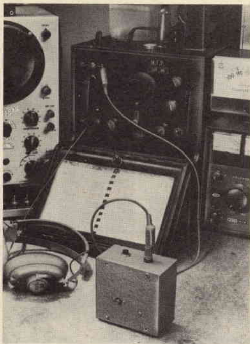
Quando è richiesta una precisione altissima, come nel controllo di un oscillatore campione, il supercalibratore accelera e facilita l'operazione.
