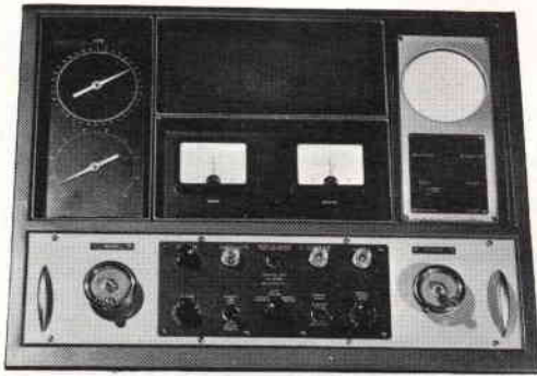
Unità indicatrice e di controllo del nuovo radar meteorologico prodotto dalla Cossor.
