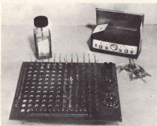
Dopo che le linguette di ancoraggio ed i commutatori sono stati installati, le lampade al neon sono fissate nelle rispettive aperture mediante collante. Tenete il collante ben distante dai fili.
