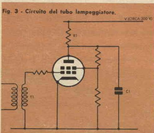
Fig. 3 - Circuito del tubo lampeggiatore.
