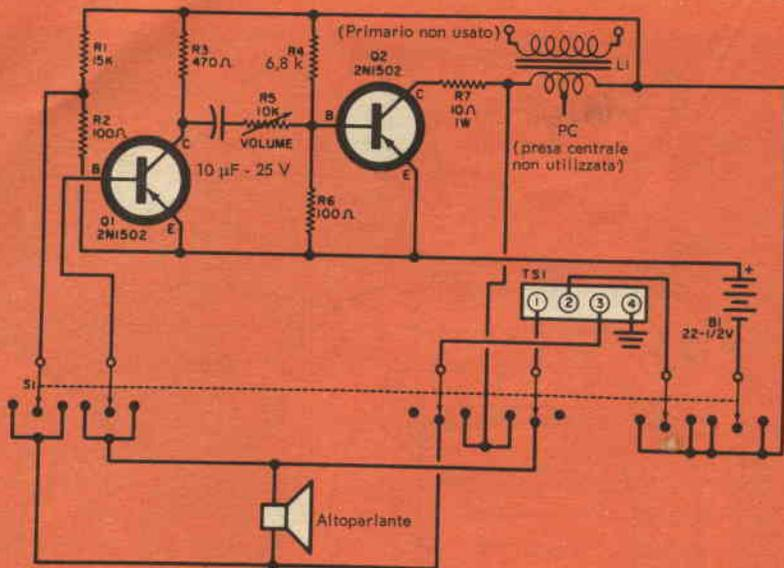
L'amplificatore transistorizzato a due stadi è l'elemento essenziale di ciascuna stazione. Le connessioni esterne con cavo sono fatte alla morsetteria TS1.
