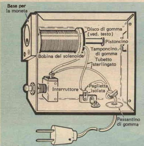
Praticate sempre nella parte superiore della scatola, ma all'interno, due piccoli fori per fissare con due viti l'estremo in plastica del rocchetto del solenoide ed altri due fori per fissare il pezzetto di legno che servirà da sostegno per la moneta. Infine fate ancora due fori sul lato della scatola opposto a quello ac-
