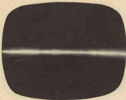
La mancanza completa di deflessione verticale appare come una sola linea orizzontale molto luminosa al centro dello schermo; si sostituisca o il tubo oscillatore verticale o quello d'uscita verticale od entrambi.
