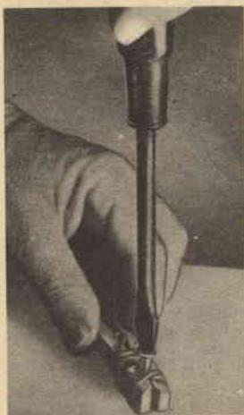
L'inserzione di una vite da legno è semplificata dall'uso di un appoggio costituito da una pinzetta per biancheria. Sistemando la vite fra i becchi della pinzetta, questa sosterrà lo sforzo e le sollecitazioni che diversamente dovrebbero sopportare le dita.
