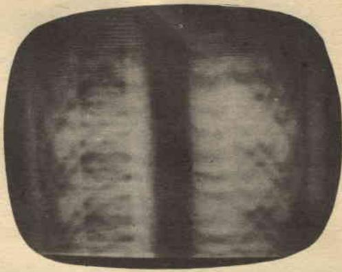
Un tubo oscillatore verticale guasto può cambiare completamente la frequenza di deflessione: l'immagine scorre rapidamente e non è possibile fermarla regolando il controllo di sincronismo verticale; in tali casi si deve sostituire il tubo oscillatore verticale e regolare i controlli di sincronismo e di altezza.
