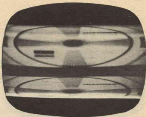
L'immagine può scorrere lentamente e apparire stirata se la deflessione verticale è eccessiva; occorre regolare il controllo di altezza e quello di sincronismo verticale; se ciò non basta a porre rimedio al difetto, bisogna sostituire il tubo oscillatore verticale.
