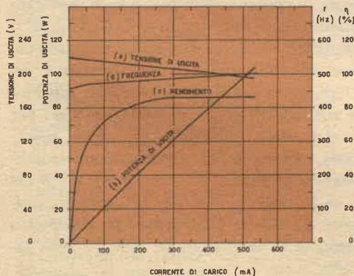
corrispondente alla somma della corrente circolante nel carico, della corrente di magnetizzazione del trasformatore di uscita e della corrente di reazione necessaria ad assicurare l'innesco. Data la necessità di evitare la saturazione del trasformatore di uscita, l'intensità della corrente di saturazione risulta soltanto una piccola frazione della corrente circolante nel carico.
