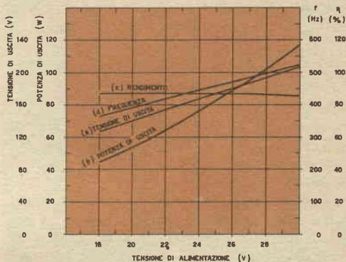
**Tensione di uscita, potenza di uscita, rendimento e frequenza di funzionamento in funzione della tensione di alimentazione.**
