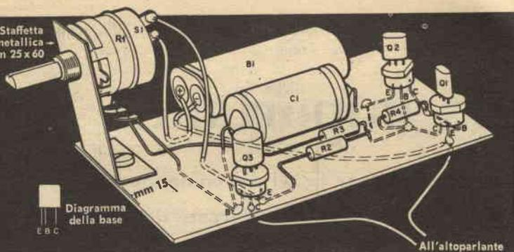
Le linee tratteggiate indicano i fili che corrono sotto la tavoletta. Il dado di fissaggio del potenziometro R1 fissa anche il telaio al lato del mobile.
