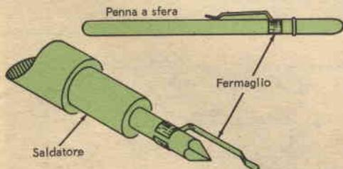
Potete saldare componenti miniatura su un circuito stampato con un saldatore di grosse dimensioni costruendovi una piccola punta per saldatore con il fermaglio di una comune penna a sfera.
