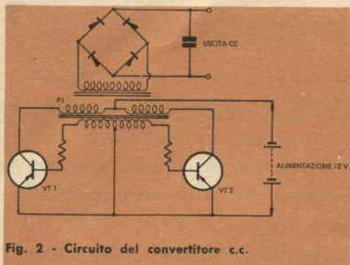
Fig. 2 - Circuito del convertitore c.c.
