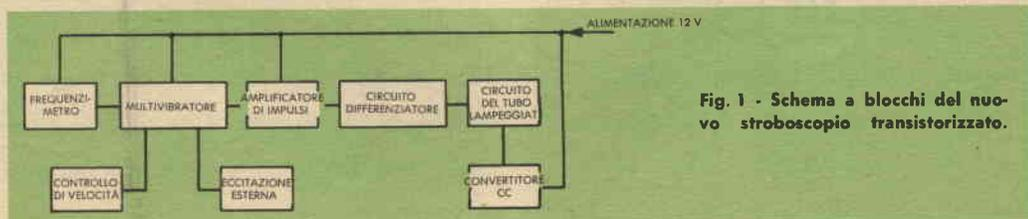
Fig. 1 - Schema a blocchi del nuovo stroboscopio transistorizzato.
