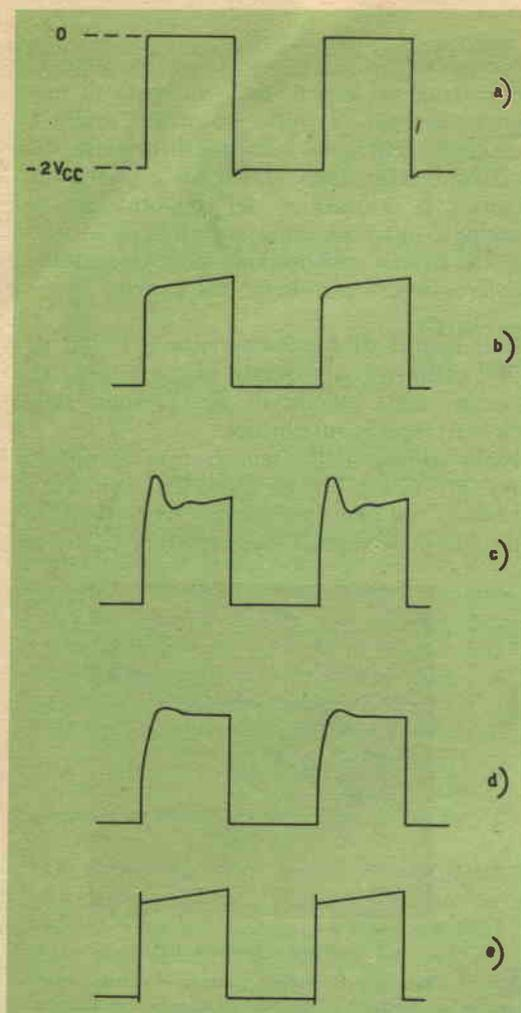
Fig. 5 - Forma d'onda della tensione e della corrente del convertitore; a) tensione di collettore; b) corrente di collettore con carico ohmico di 375  $\Omega$ ; c) corrente di collettore con carico shuntato da un condensatore da 0,5  $\mu\text{F}$ ; d) corrente di collettore con carico shuntato da un condensatore da 100  $\mu\text{F}$ ; e) corrente di collettore con impiego di filtro a ingresso induttivo.
