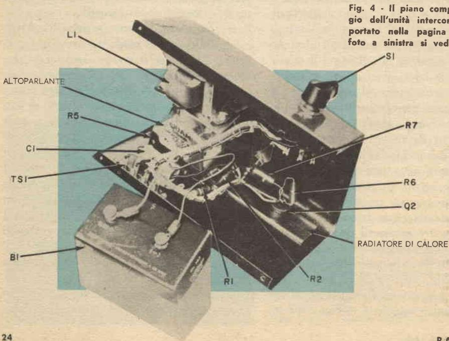
Fig. 4 - Il piano completo di cablaggio dell'unità intercomunicante è riportato nella pagina accanto. Nella foto a sinistra si vede l'unità finita.
