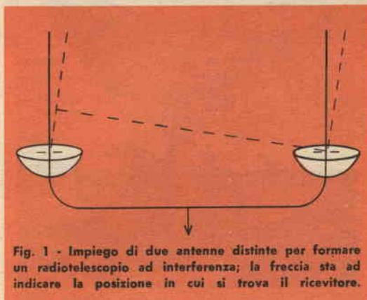
Fig. 1 - Impiego di due antenne distinte per formare un radiotelescopio ad interferenza; la freccia sta ad indicare la posizione in cui si trova il ricevitore.
