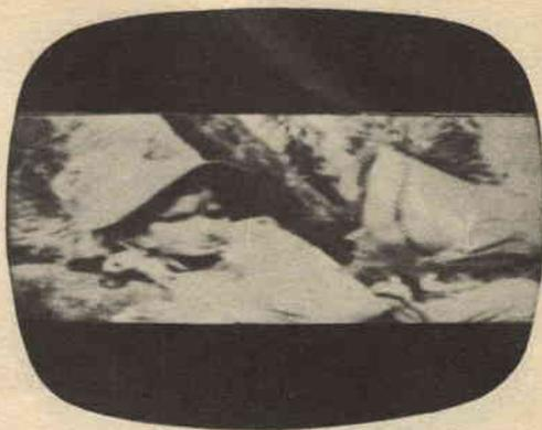
L'altezza insufficiente può essere corretta mediante i controlli di altezza e linearità verticale; se ciò non è possibile, né si ottiene un miglioramento sostituendo i tubi oscillatore e d'uscita verticale, si provi ancora a sostituire il tubo raddrizzatore a bassa tensione.
