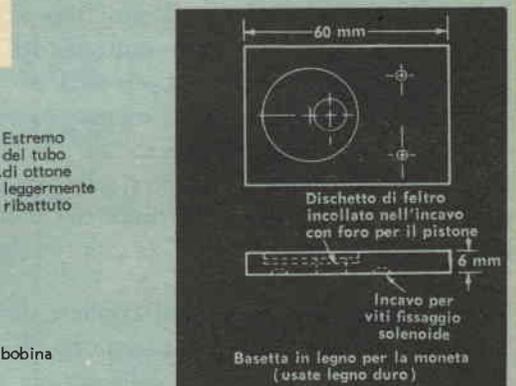
scatola mediante due viti. Prendete un altro pezzo di gomma e incollatelo al fondo della scatola esattamente sotto la bobina, in modo che faccia da tamponcino di arresto per il pistoncino quando ricade in basso. La basetta di appoggio per la moneta è ricavata da una tavoletta di legno nella quale viene praticato un incavo di dimensioni tali da contenere esattamente la moneta che si vuole lanciare.
