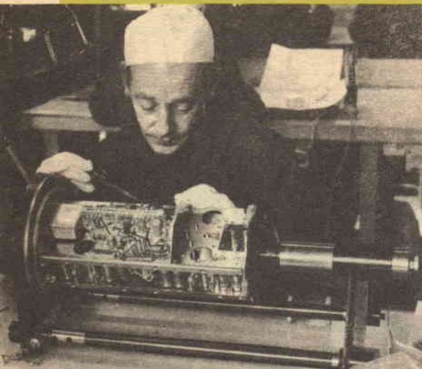
Un tecnico monta un'unità d'amplificazione ripetitrice che sarà utilizzata nel nuovo sistema telefonico che entro il 1961 unirà l'Inghilterra al Canada.
