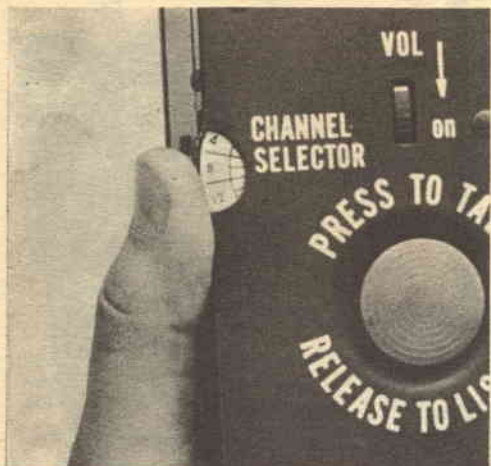
Particolare del ricetrasmittitore costruito dalla Electro Voice; sono visibili nella foto il selettore del canale ed il commutatore a pulsante ascolto-trasmisione.
