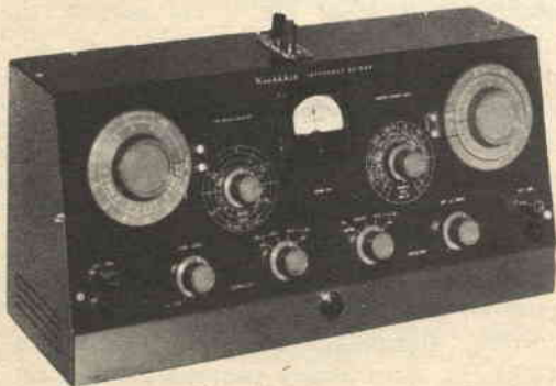
Ponte multiplo di costruzione americana.
