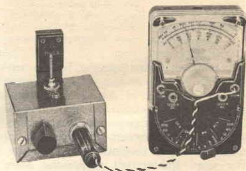
Il trasmettitore con diodo a tunnel viene regolato da uno strumento esterno con il quale è possibile determinare la regione di resistenza negativa del diodo.
