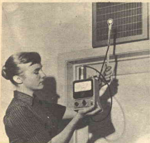
Con un elettrometro munito di sonda si rileva la presenza di aria ionizzata. L'apparecchio riprodotto nella foto determina se il condizionatore sta emettendo aria ionizzata.
