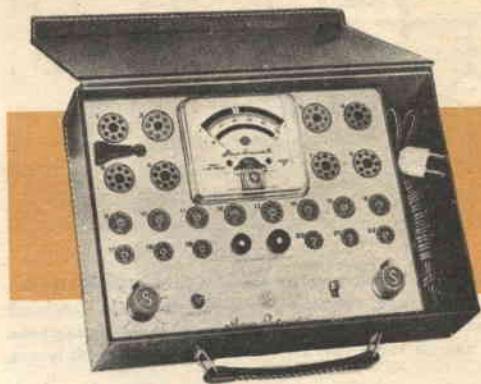
Il provavalvole « rapido » qui illustrato ha numerosi zoccoli con connessioni permanenti, così da ridurre il tempo necessario per le regolazioni preliminari.
